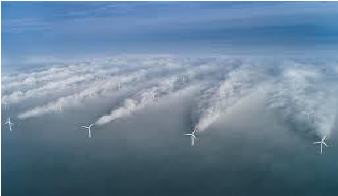
図2 ホーン Rev1 は、80 基の風力タービンを持ち 2002 年に稼働を始めた発電量 160MW のデンマーク西海岸沖にある風力発電ファームです。上の写真は、風力タービンの下流の乱流場を示します。2008 年 2 月 12 日の特殊な気象条件は、非常に湿った空気の凝縮（すなわち雲）を引き起こし、結果として風力タービンの後ろの乱流パターンが見えるようになりました。
